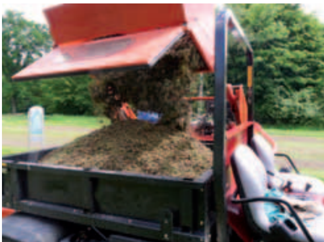
Durch Hochentleerung bis auf 1,5 m arbeiten praktisch alle Utility-Fahrzeuge mit dem Core Recycler zusammen. (Foto: Wiedenmann)
