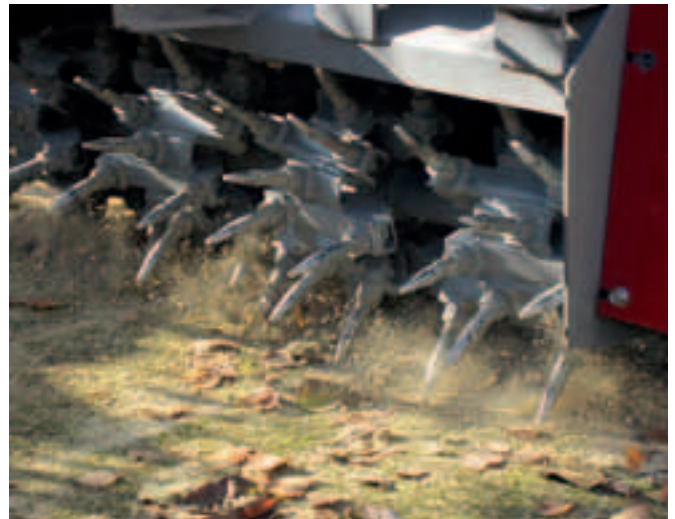
Durch die Vibration und Taumelbewegung werden nicht nur die Einstichlöcher belüftet und gelockert, sondern auch das gesamte Umfeld.
