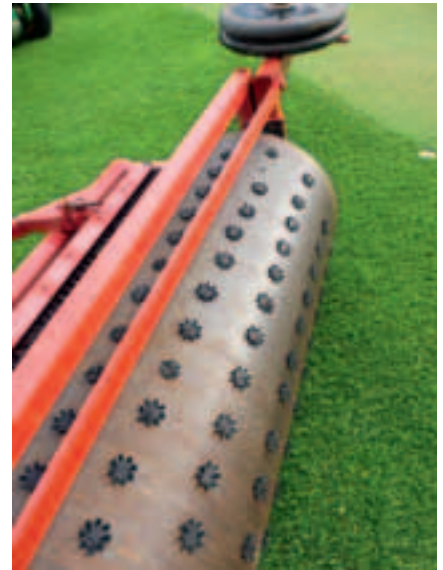
Abb. 7: Walze mit Soft-Spikes zur Simulation der Belastung von Rasenflächen durch Golfschuhe.
